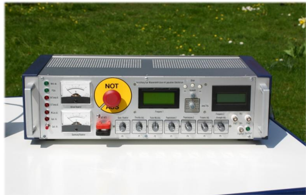
Steuergerät für den Wasserelektrolysereaktor
