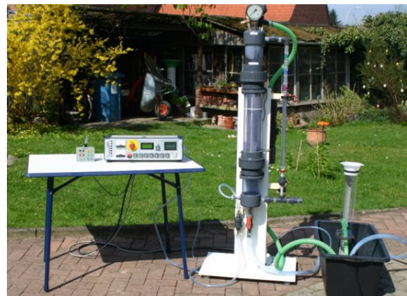
Der Versuchsaufbau mit dem Wasserelektrolyseaktor
