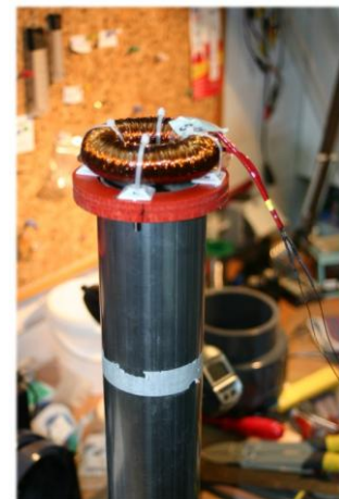
Toroidspule oberhalb der Elektroden
